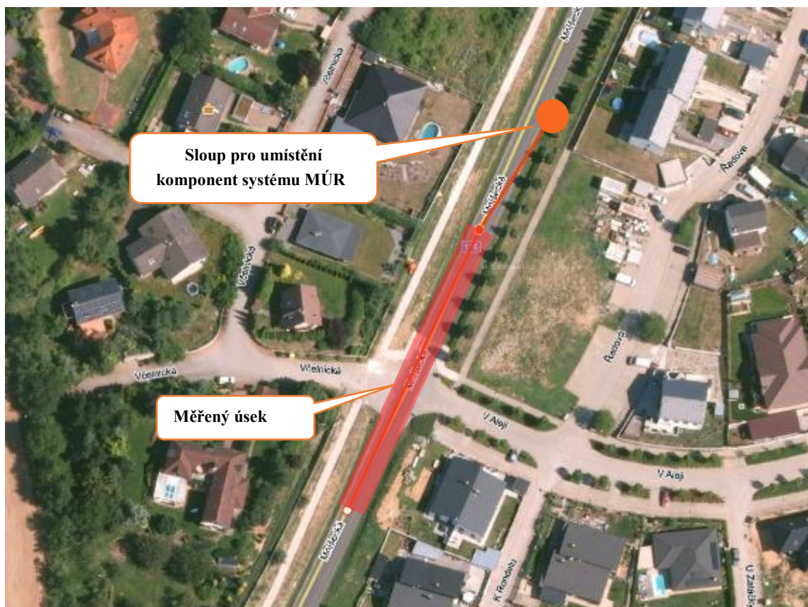
Obr. 8 Navržené opatření Mníšecká, silnice I/116
